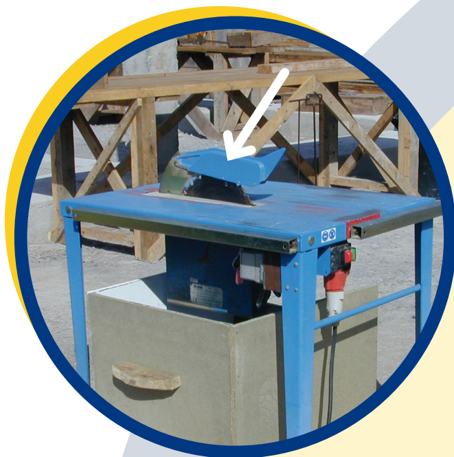
Boîtier de protection d'une scie à disque.
