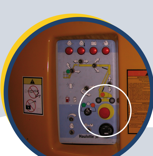
Dispositif d'arrêt d'urgence sur une plate-forme élévatrice.
