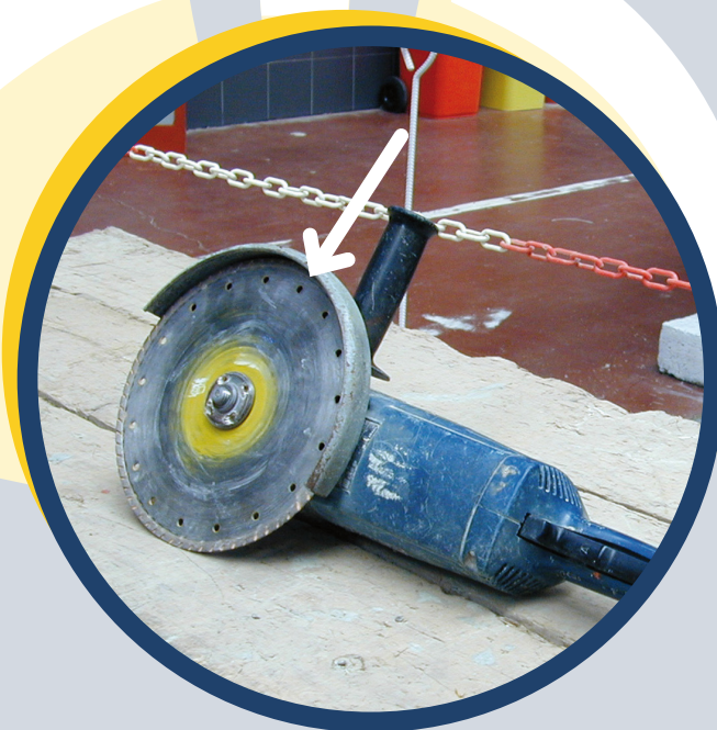
Boîtier de protection d'une scie radiale.
