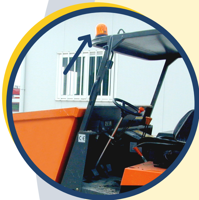
Détail d'un dispositif lumineux d'un tombereau
