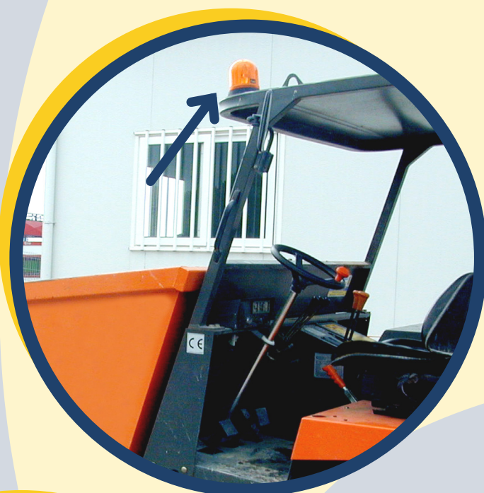
Dettaglio di un dispositivo luminoso di un dumper.
