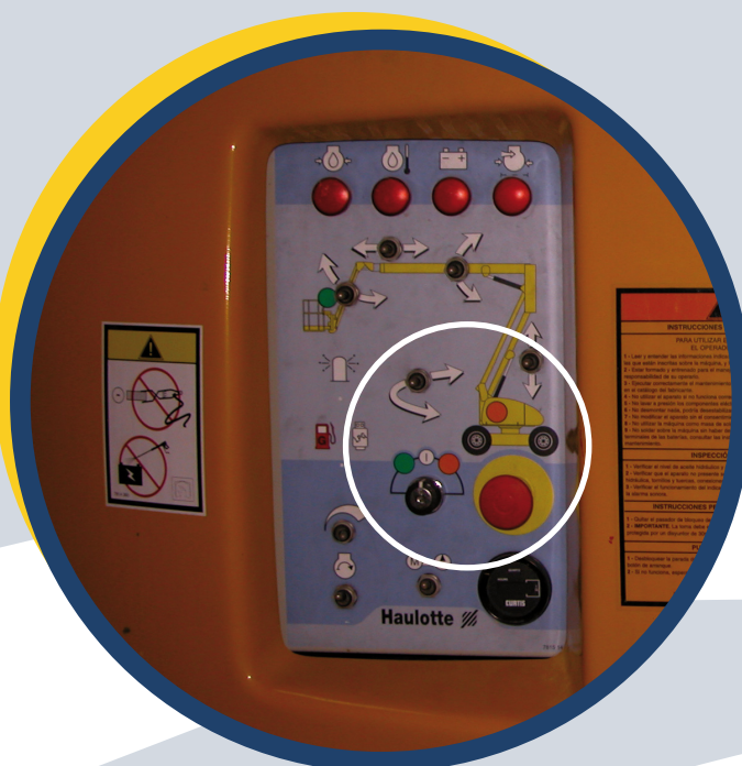
Dispositivo di arresto di emergenza su una piattaforma elevatrice.
