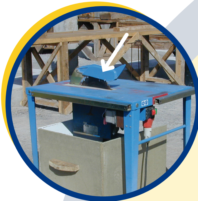
Carcaça protetora de uma serra circular.
