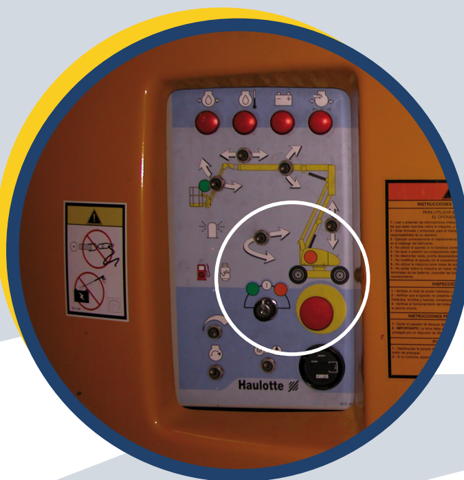
Dispositivo de paragem de emergência numa plataforma elevatória
