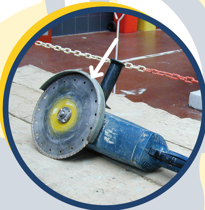
Carcaça protetora de uma radial.
