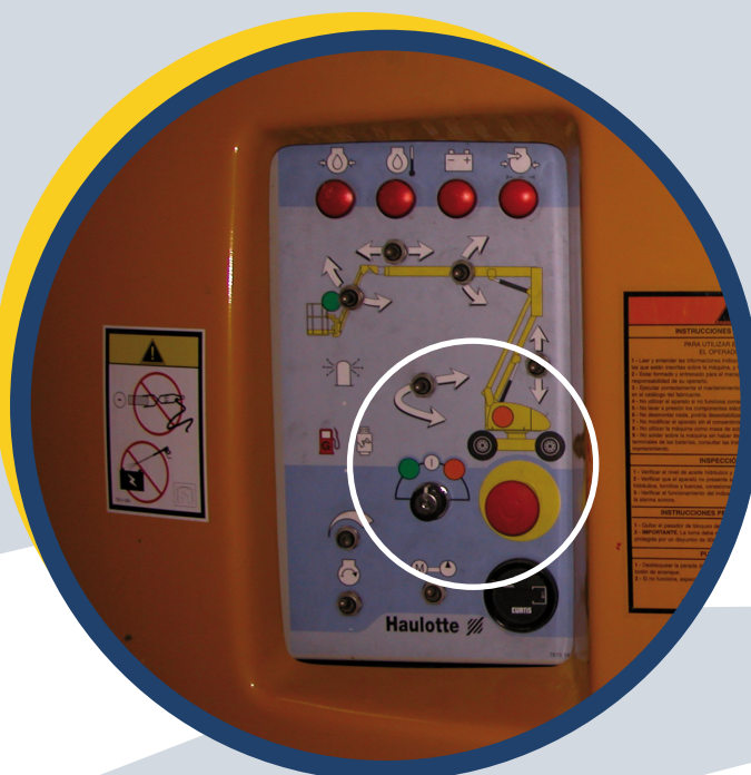
Dispozitiv de oprire de urgență pe o platformă elevatoare.
